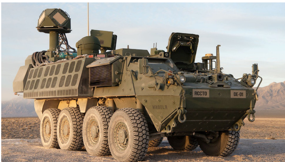
Figura 4 – DE M-SHORAD montado en un blindado Stryker
