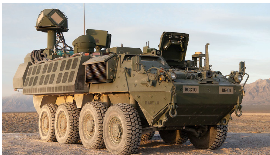
Figura 4 – DE M-SHORAD montado em um blindado Stryker
