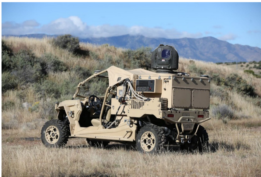
Figura 3 – HELWS montado em um veículo Polaris MRZR ( dune buggy )
